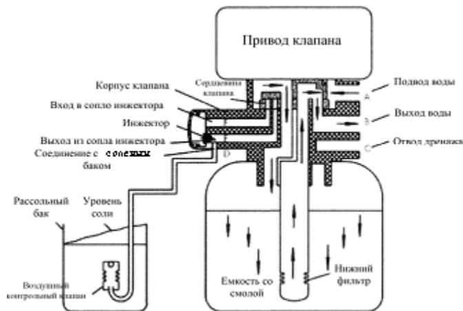
Исходная вода поступает в клапан на вход А, далее через корпус клапана в верхней части сердцевины клапана и поступает в бак (по наружной части подъемной трубы бака). Далее вниз через слой смолы для умягчения, после этого проходит через нижний фильтр и возвращается по подъемной трубе, двигаясь вверх, через сердцевину клапана к выходному каналу В.
