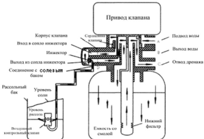
Необработанная вода поступает на вход А, далее через сердцевину клапана к соплу инжектора F, проходя через которое с высокой скоростью и выходя через канал E, создается разряжение, что позволяет свободно засасывать солевой раствор в клапан. Далее раствор движется вниз через слой смолы, нижний фильтр и возвращается по подъемной трубе, двигаясь вверх, через сердцевину клапана к выходному каналу С.
