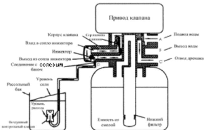
Исходная вода поступает в клапан по каналу А, далее через сердцевину клапана к выходному соплу инжектора Е, далее через соединительный разъем D вода заполняет рассольный бак. Другая часть воды направляется вверх через маленькое отверстие во входном сопле инжектора F, сердцевину клапана к выходному каналу С.
