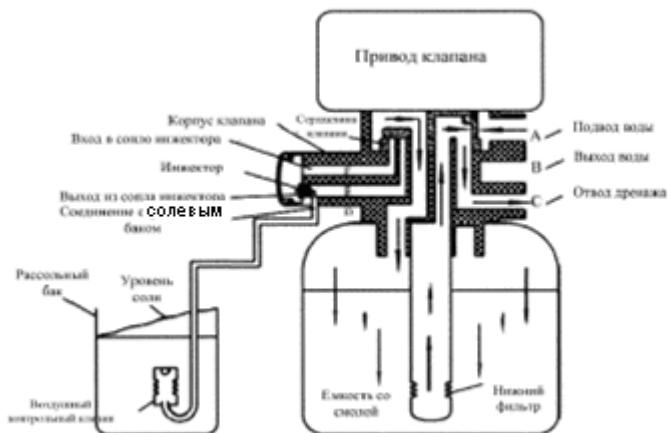
Исходная вода поступает в клапан по каналу А, далее через корпус клапана в верхней части сердцевины клапана и поступает в бак, далее через слой смолы и нижний фильтр вода попадает в подъемную трубу. Двигаясь вверх, по подъемной трубе поднимается и через сердцевину клапана попадает к выходному каналу С.
