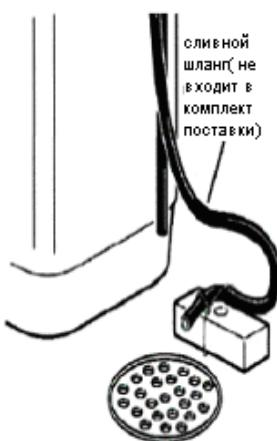
Регулировочный клапан должен располагаться выше, чем отвод дренажной воды и по возможности ближе к сливу.
