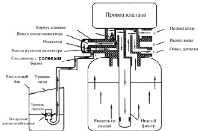
Исходная вода поступает на вход А, далее через сердцевину клапана к соплу инжектора F, проходя через которое с высокой скоростью и выходя через канал E, создается разряжение, что позволяет свободно засасывать солевой раствор в клапан. Далее раствор движется вниз по подъемной трубе, нижний фильтр и попадает в бак. Затем направляется вверх через слой смолы, сердцевину клапана к выходному каналу С.
