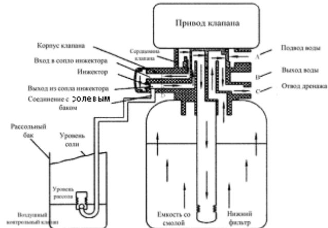
После того, как весь солевой раствор закончился, исходная вода продолжает поступать в клапан по каналу А, далее через сердцевину клапана, инжектора вода движется вниз по подъемной трубе, в нижний фильтр и попадает в бак. Затем направляется вверх через слой смолы, сердцевину клапана к выходному каналу С.
