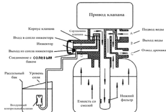
Исходная вода поступает на вход клапана, далее через корпус клапана в верхней части сердцевины клапана и поступает в нижнюю часть бака (по внутренней части подъемной трубы). Далее вверх через слой смолы, двигаясь вверх, через сердцевину клапана к выходному каналу С.
